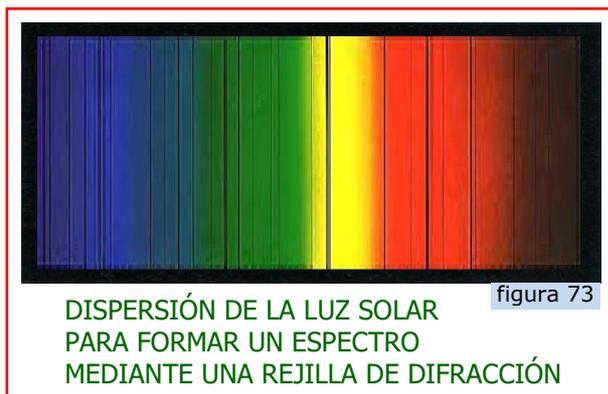
Cuando la luz que se ha generado en el interior del Sol atraviesa la atmósfera de éste, se absorben selectivamente ciertas longitudes de onda. Por esta razón, el espectro de luz solar que se obtiene mediante una rejilla de difracción presenta líneas de absorción oscuras, como se aprecia en la [figura 73](#). Los experimentos
